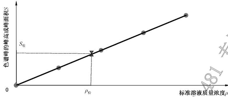
图 1 标准曲线法校准曲线
