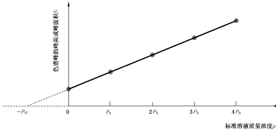
图 2 标准加入法校准曲线
